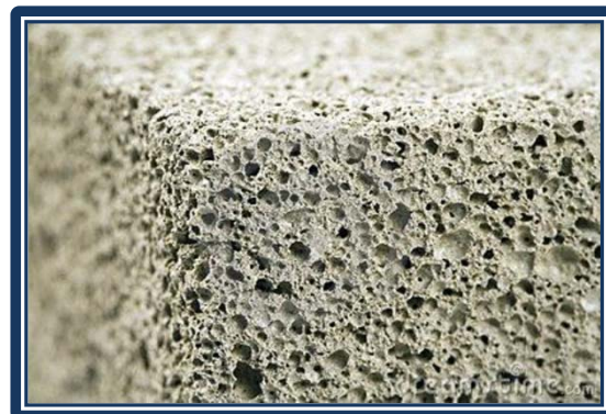
CONCRETO LIGERO ELABORADO DE MATERIALES NATURALES
